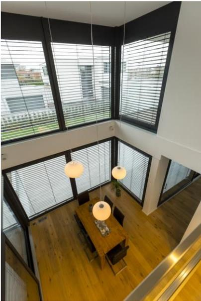
Automatisierte Raffstoren dienen als Blendschutz und reflektieren die Sonneneinstrahlung. Mit der Automatisierung über DuoFern Connect-Aktoren von Rademacher kann das junge Paar die Lamellen zudem problemlos in jede gewünschte Position und Stellung fahren.
